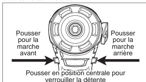
Pour une rotation **en marche avant** (dans le sens horaire), pousser le commutateur sur le côté droit de l'outil. **Vérifier la direction de rotation avant utilisation.**
