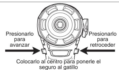
Para **avanzar** (el giro es en el sentido de las manecillas del reloj), se presiona el interruptor de control colocado al lado derecho del taladro. **Verificar la dirección del giro antes de usarlo.**
